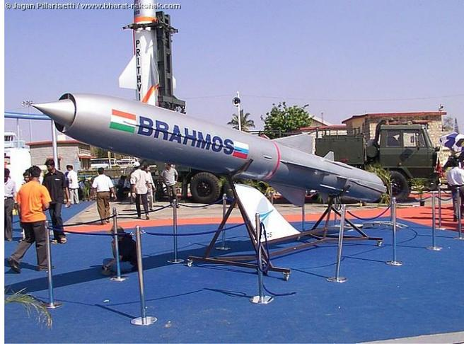
Caractéristique essentielle du BrahMos, sa vitesse supersonique<sup>12</sup>, couplée avec une capacité de vol à basse altitude et une surface équivalente radar (SER) réduite, limite sa vulnérabilité face aux moyens de défense aériens existants. Il s'agit vraisemblablement, de ce fait, du missile antinavires le plus performant du monde aujourd'hui.
